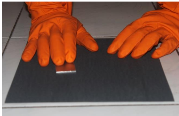
Gambar 3.31 Proses Pengamplasan Spesimen
