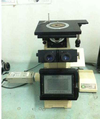
Gambar 3.9 Alat Uji Foto Optik Magnifikasi 100X
