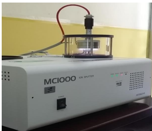
Gambar 3.41 Proses Coating Spesimen
