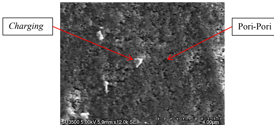
Gambar 4.14 Foto SEM aluminium anodizing selama 10 menit dengan magnifikasi 12000 kali
