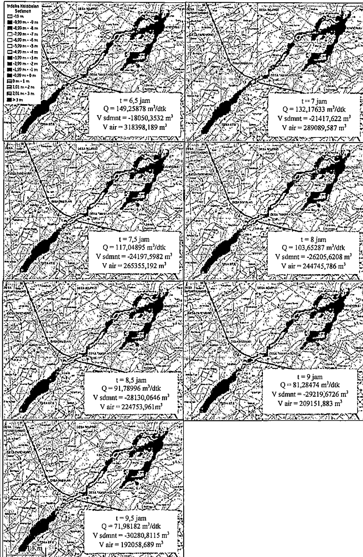
Gambar 5.23 Hasil Simulasi lahar efektifitas sabo dengan tinggi hujan 34 mm
