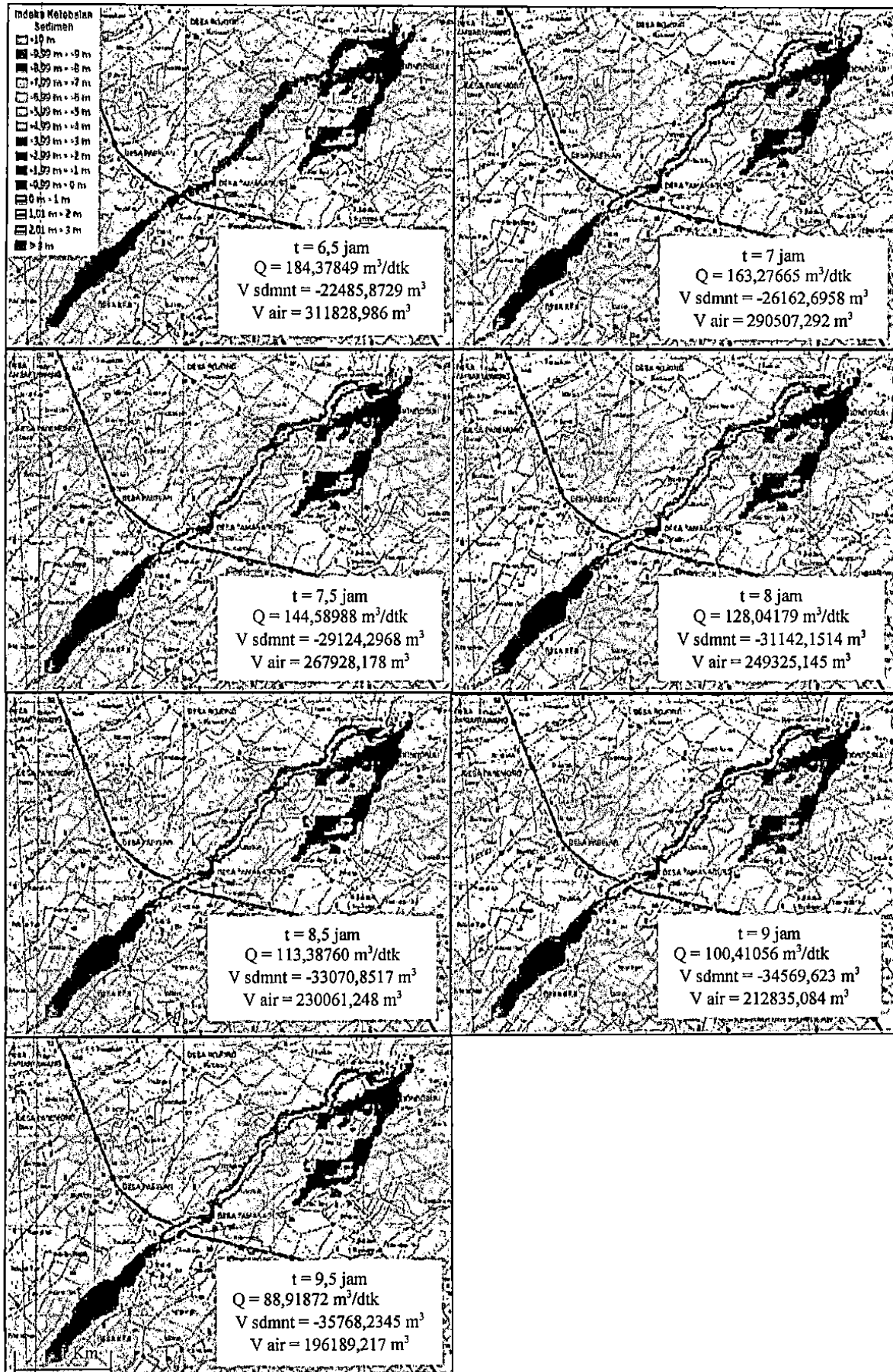
Gambar 5.16 Hasil simulasi lahar tanpa sabo dengan tinggi hujan 42 mm
