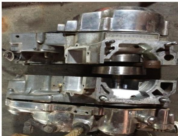
Gambar 2.13 Bak mesin
