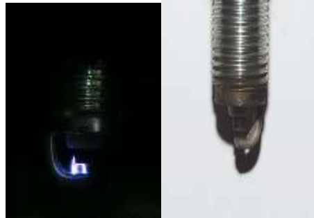
Gambar 4.1 Hasil pengujian percikan bunga api kondisi standar (Busi Denso Standar-CDI Standar)
