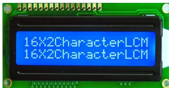
Gambar 2.7. Skematik LCD 2x16
