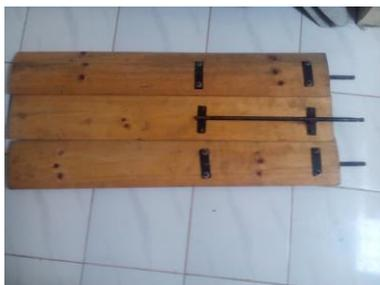
Gambar 3.10 *Blade* yang sudah dirakit dengan stik *blade*
