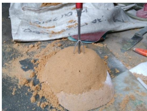
Gambar 4.16 Pemberian gas \text{CO}_2 pada bagian dalam piston
