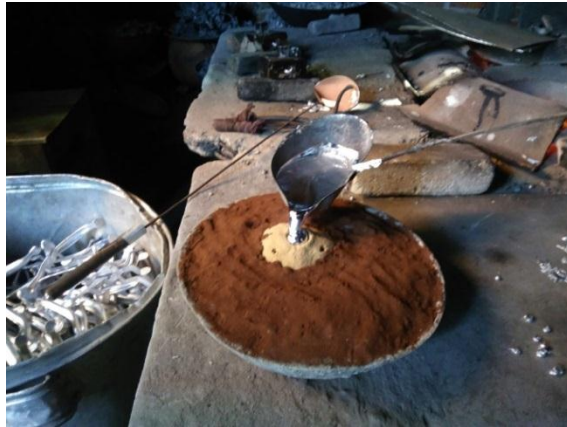
Gambar 4.25 Proses penuangan logam cair
