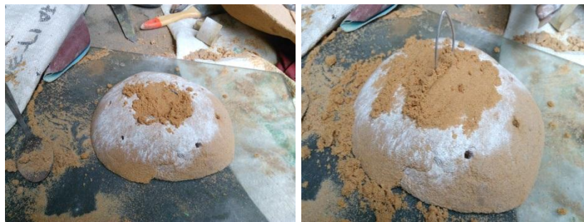
Gambar 4.15 Pembuatan cetakan dalam piston
