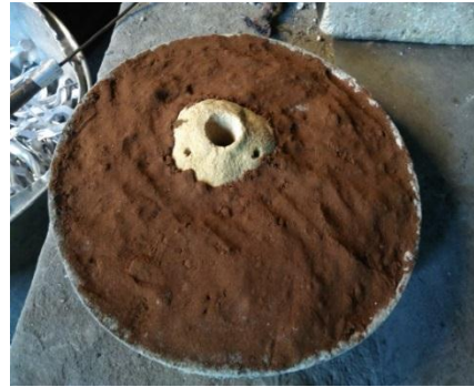
Gambar 4.23 Peleburan material Gambar 4.24 Cetakan siap tuang
