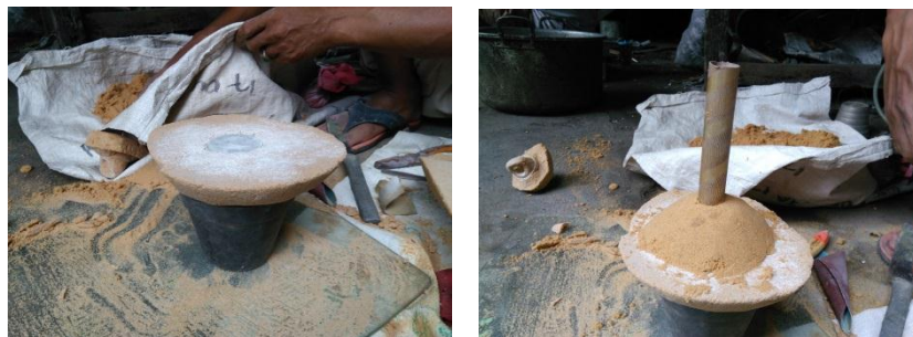
Gambar 4.18. Proses akhir pembuatan cetakan pola
