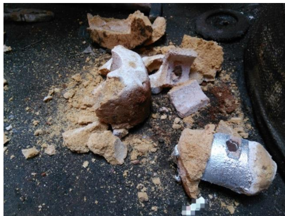
Gambar 4.26 Pembongkaran cetakan piston
