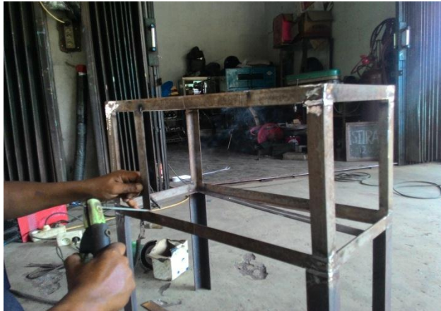
Gambar 3.16 Pembuatan Rangka Alat Uji
