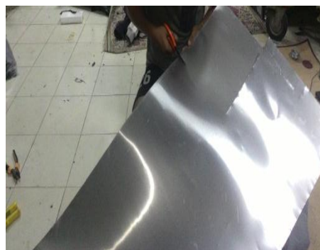
Gambar 3.17 Pemotongan Lempengan Aluminium
