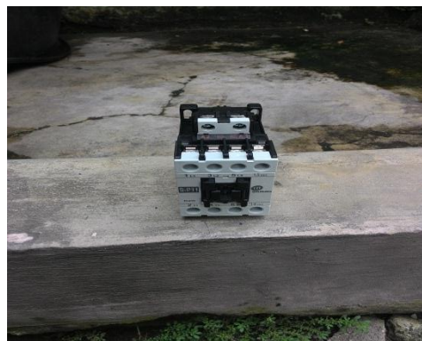
Gambar 3.9 Magnetic Contactor atau kontak magnet
