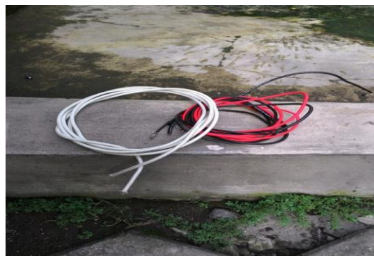
Gambar 3.7 Kabel kawat dan kabel insulator heater
