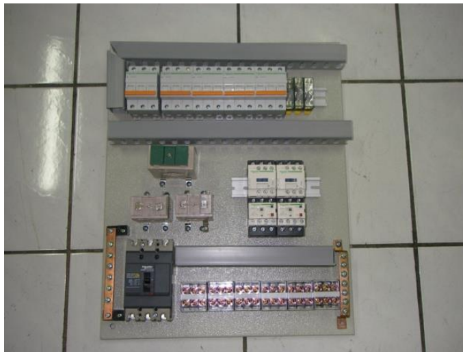
Gambar 2.7. Isi Panel Distribusi Listrik Sebelum Pengawatan (Pengkabelan) (Sumber: http://utakatikmikro.wordpress.com )
