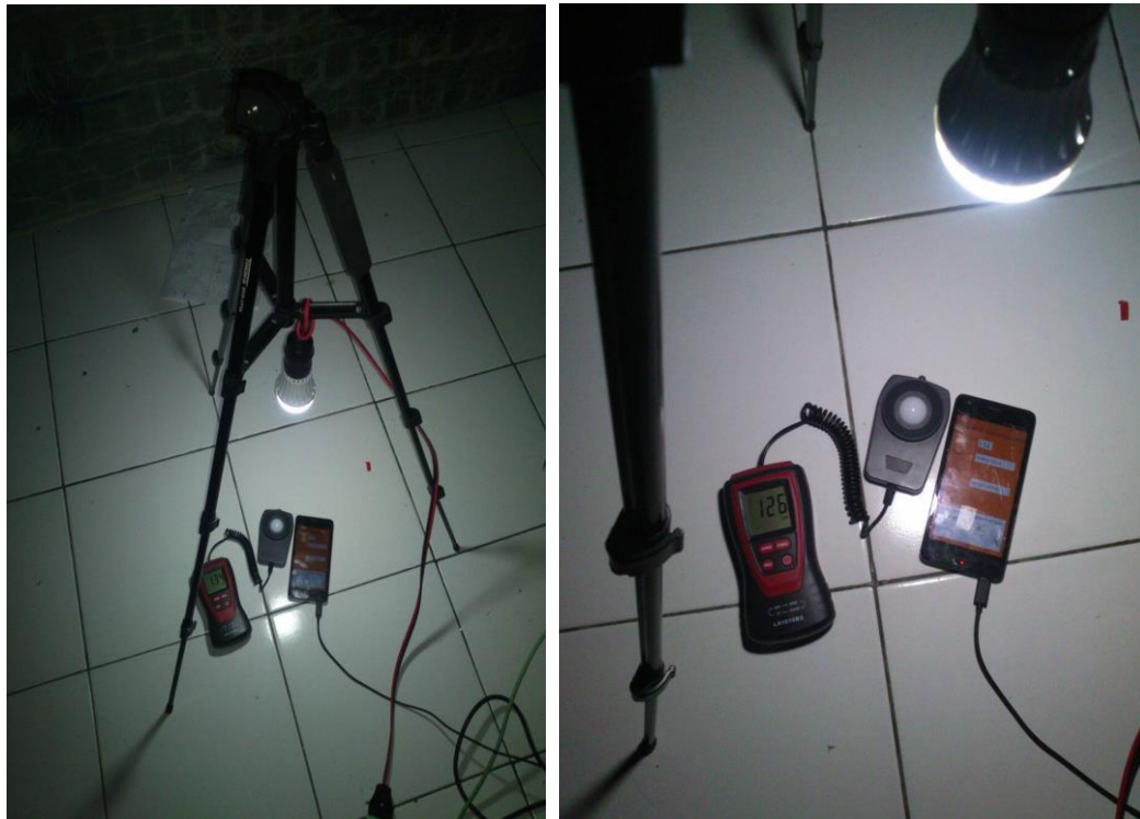
Gambar 3. Cara pengkalibrasian aplikasi lux meter dengan digital lux meter
