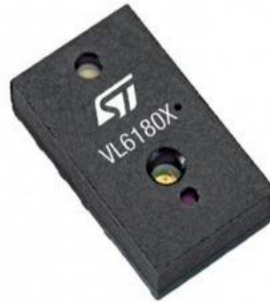
Gambar 1. Perangkat ambient light sensor satu paket dengan proximity sensor
