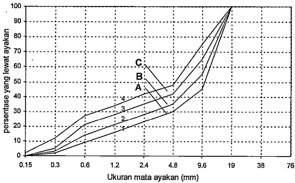
Gambar 3.3. Batas gradasi kerikil besar butir maksimum 20 mm
