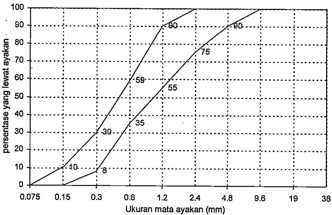
Gambar 3.2b. Batas gradasi pasir daerah no. 2
