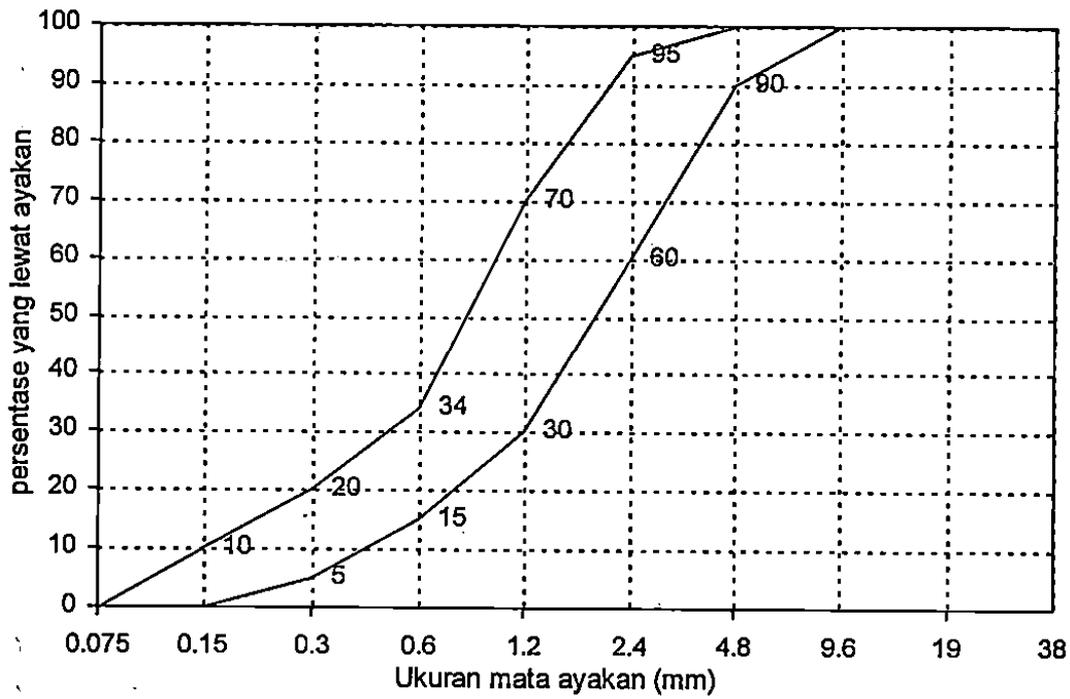
Gambar 3.2a. Batas gradasi pasir daerah no. 1
