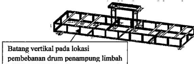
Gambar 4.28 Batang vertikal pada lokasi pembebanan drum penampung
