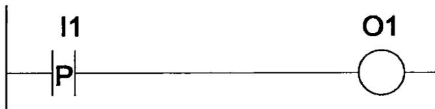
Gambar 2.20. Diagram Ladder dari Positive Transition Contact
