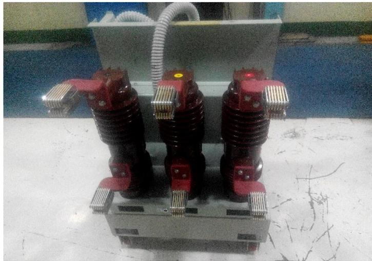
Gambar 2.6. Pemutus Tenaga (PMT) { *Circuit Breaker (CB)* }.
