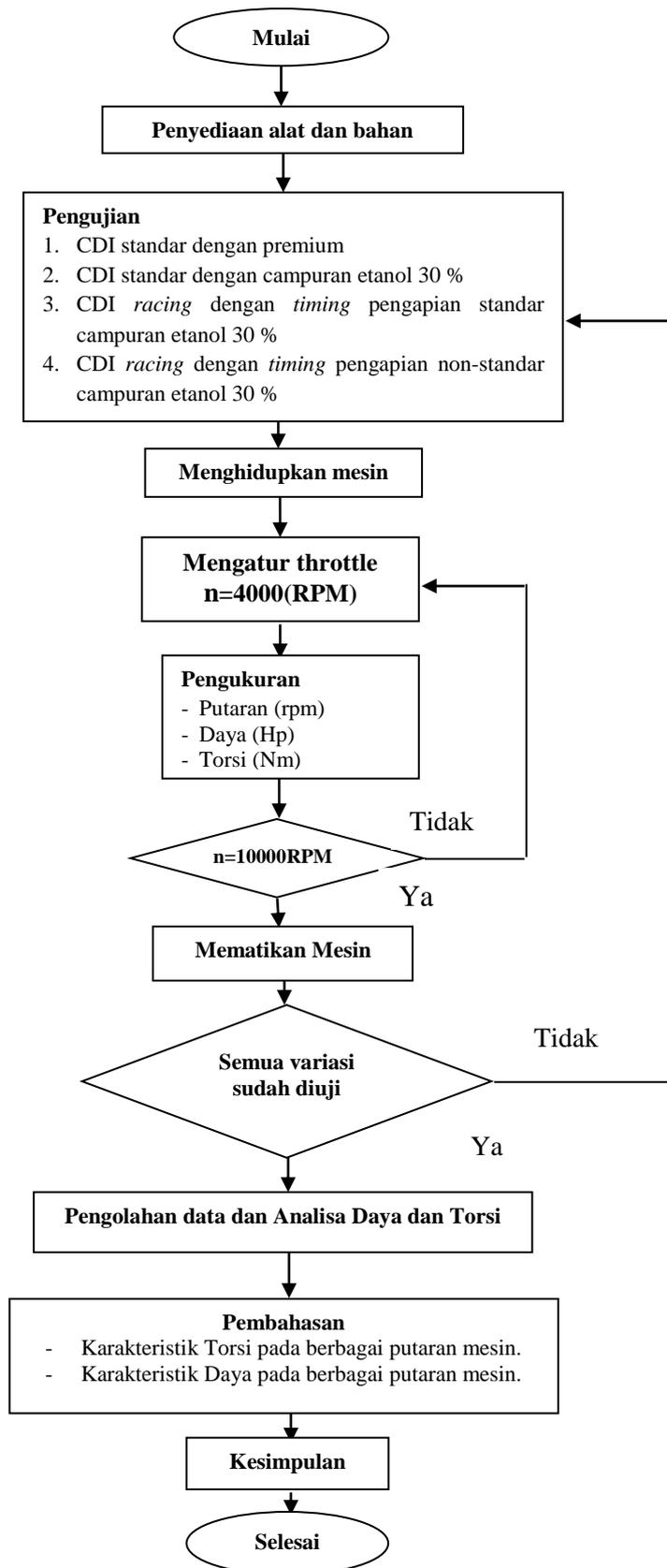
**Gambar 3.5.** Flow chart Pengujian Daya dan Torsi.
