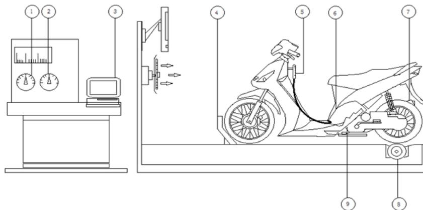
**Gambar 3.7.** Skema Alat Uji Daya dan Torsi Motor.
