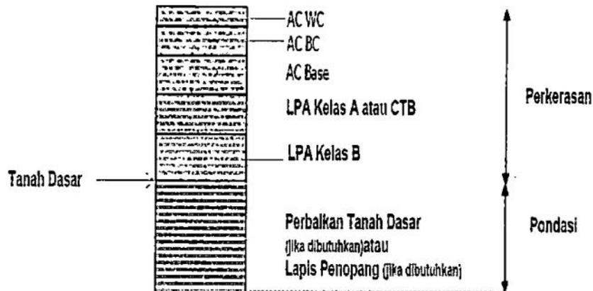
Gambar 2.1 Konstruksi perkerasan jalan pada permukaan tanah asli
