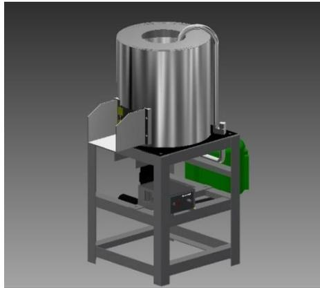
**Gambar 3.2 Mesin Pengupas Kulit Kentang**
