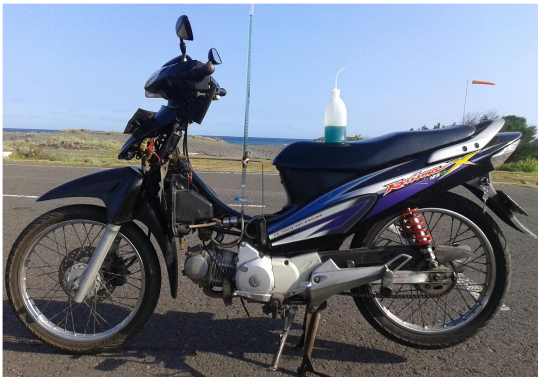
Gambar 3.1. Pemasangan Buret Sebagai Pengganti Tangki.
