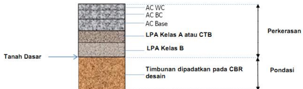
Gambar 2.3 Struktur Perkerasan Lentur (Lalu Lintas Berat) pada Tanah Timbunan
