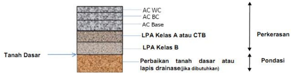
Gambar 2.4 Struktur Perkerasan Lentur (Lalu Lintas Berat) pada Galian
