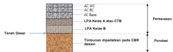
Gambar 2. Struktur Perkerasan Lentur (Lalu Lintas Berat) pada Tanah Timbunan
