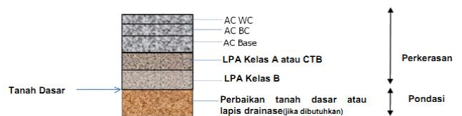
Gambar 3. Struktur Perkerasan Lentur (Lalu Lintas Berat) pada Galian
