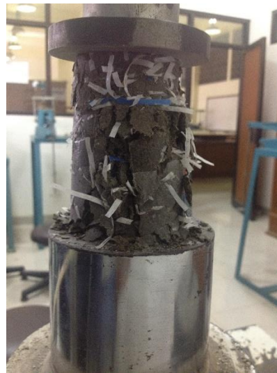
Gambar 6 Benda uji mengalami keruntuhan setelah pengujian tekan bebas.
