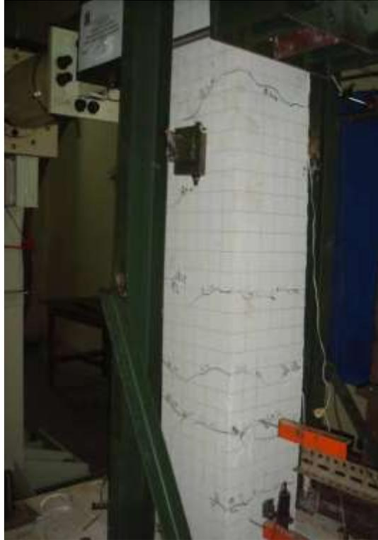
Gambar 2.3 Retak yang terjadi pada benda uji 1 (Imran, 2009).
