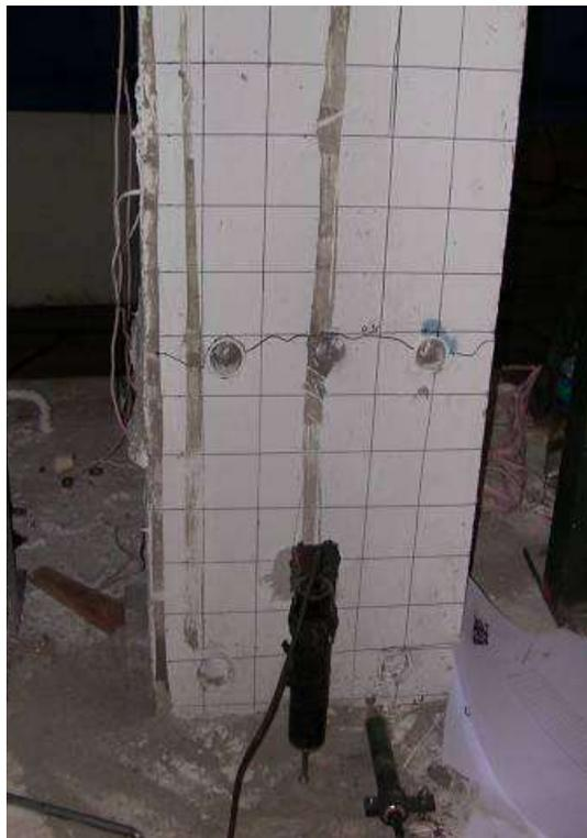
Gambar 2.4 Retak yang terjadi pada benda uji 2 (Imran, 2009).
