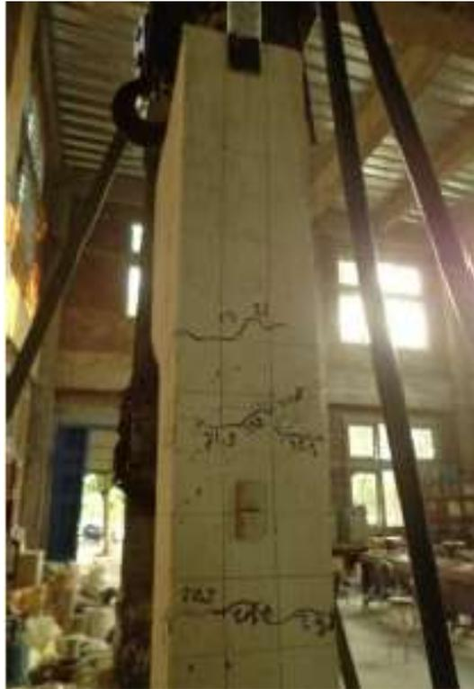
Gambar 2.1 Pola retak kolom monolit tanpa sambungan (Adi, 2014).
