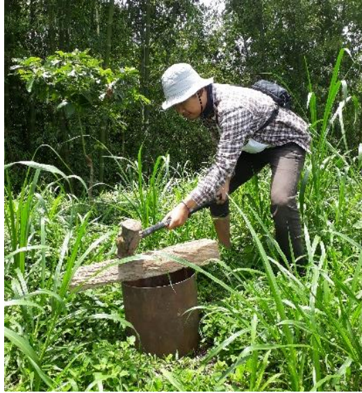
Gambar 4.15 Pemasangan double ring infiltrometer
