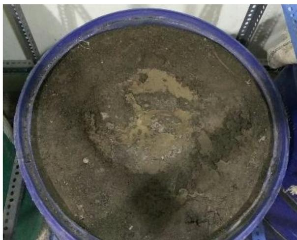
Gambar 3. 9 Kondisi tanah lempung ekspansif dalam tong percobaan
