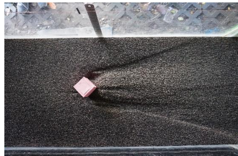
Pilar Tajam setelah running 3 menit
