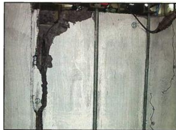
Gambar 2.10 Pola retak Benda uji Mod-B (Ertas, 2006)
