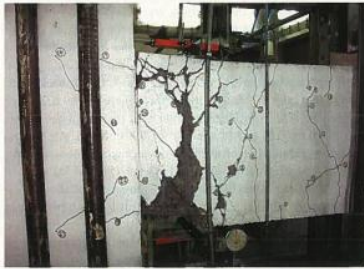
Gambar 2.6 Pola retak Benda uji monolit (Ertas, 2006)
