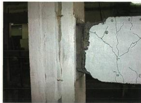
Gambar 2.9 Pola retak Benda uji GOK-W (Ertas, 2006)
