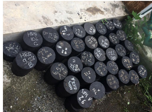
Gambar 26. Benda uji setelah uji Marshall
