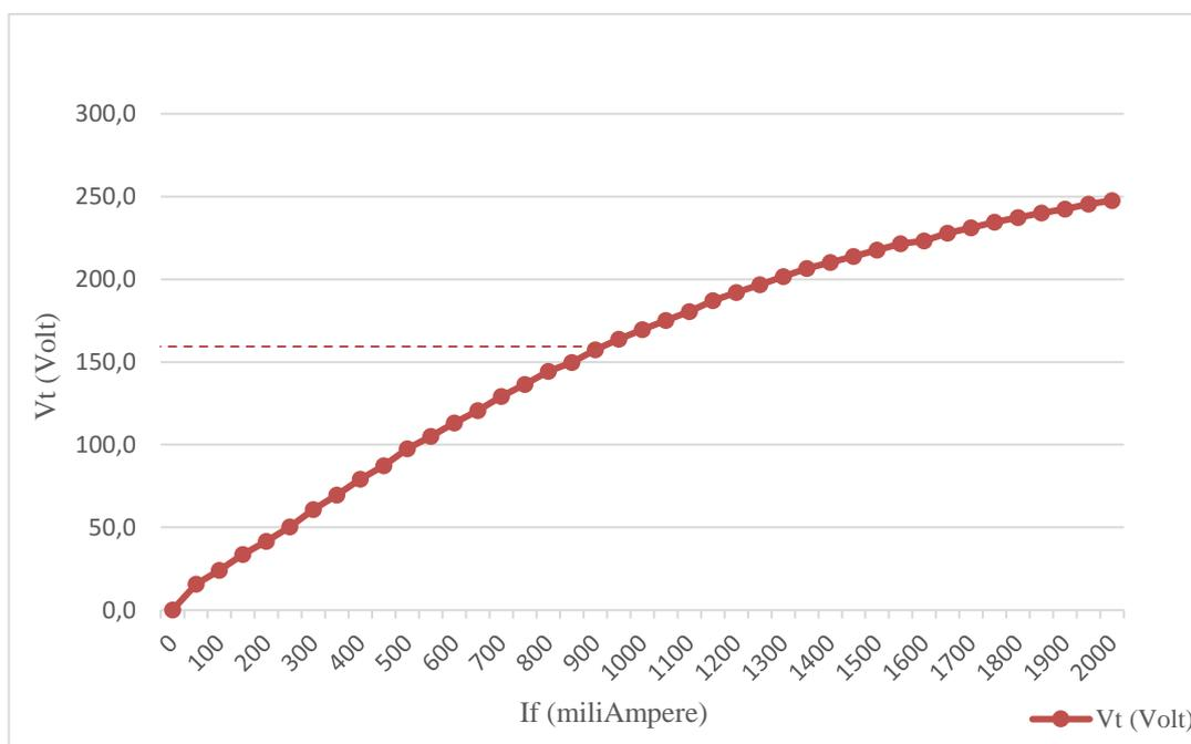
**Gambar 4.2** Kurva Karakteristik Tegangan Terminal sebagai Fungsi Arus Eksitasi Generator Sinkron Satu Fasa Tanpa Beban Dengan Penguat Terpisah
