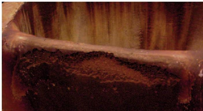
Gambar 2. 17 Erosi kavitasi pada *cutswater double volute* (Gülich 2013)
