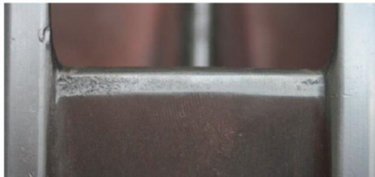
Gambar 2. 15 Kerusakan pada *leading edge impeller* tertutup (Gülich 2013)
