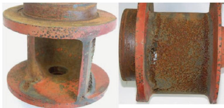
Gambar 2. 16 kerusakan *impeller* pada pompa *single-channel* (Gülich 2013)
