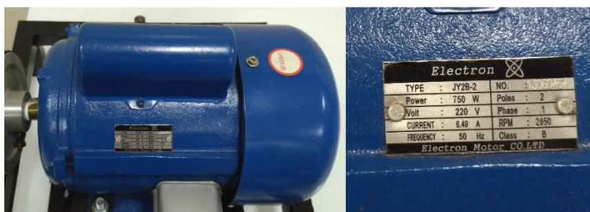
Gambar 3. 4 Spesifikasi motor listrik
