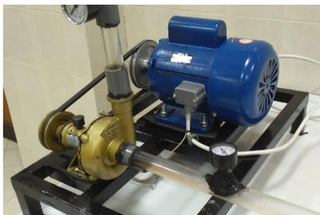
Gambar 3. 3 Pompa dan motor pada rangka/meja
