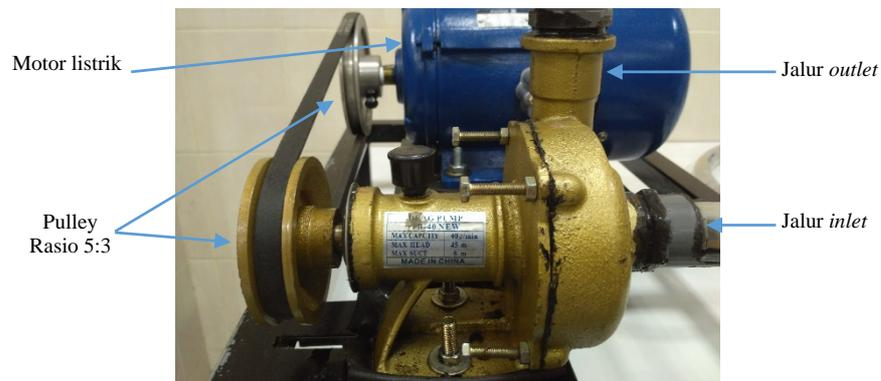
Gambar 3. 14 konstruksi pompa sentrifugal
