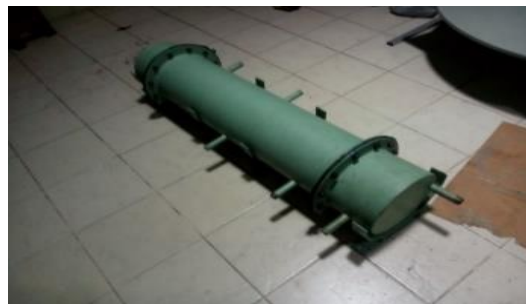
Gambar 3.4. Tangki penyimpanan air panas
