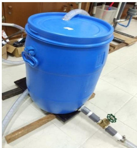
Gambar 3.16 Tangki Penampungan Air Sirkulasi
