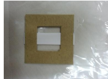
Sampel uji tarik ASTM D 882
