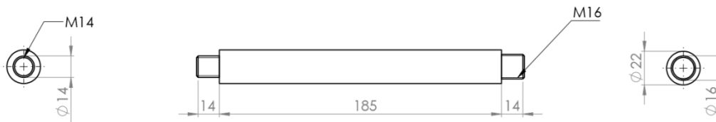
Gambar 4.26 Dimensi batang piston
