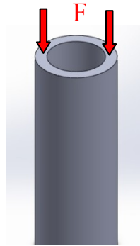
Gambar 4.11 Gaya tekan pada batang silinder
