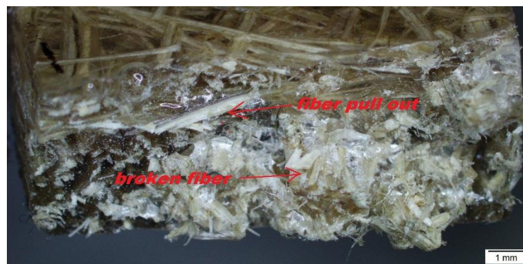
Gambar. 4.12. Variasi 4 (a) Penampang patahan tampak atas. (b) Penampang patahan tampak dari sisi diagonal.
