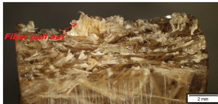
Gambar. 4.11. Variasi 3 (a) Penampang patahan tampak atas. (b) Penampang patahan tampak dari sisi diagonal.
