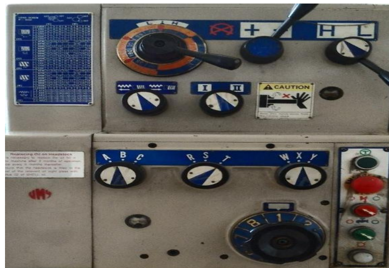
Gambar 3.14. Menyetel putaran 1000 rpm
