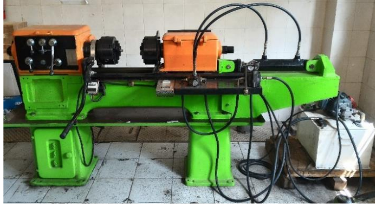
Gambar 3.2. Mesin las gesek yang digunakan sebagai las gesek alumunium 6061 T6 dan stainless steel 304
