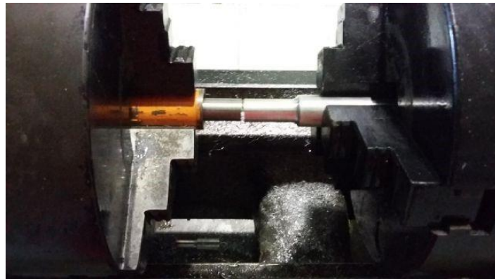
Gambar 3.13. Pemasangan bahan diposisikan center
