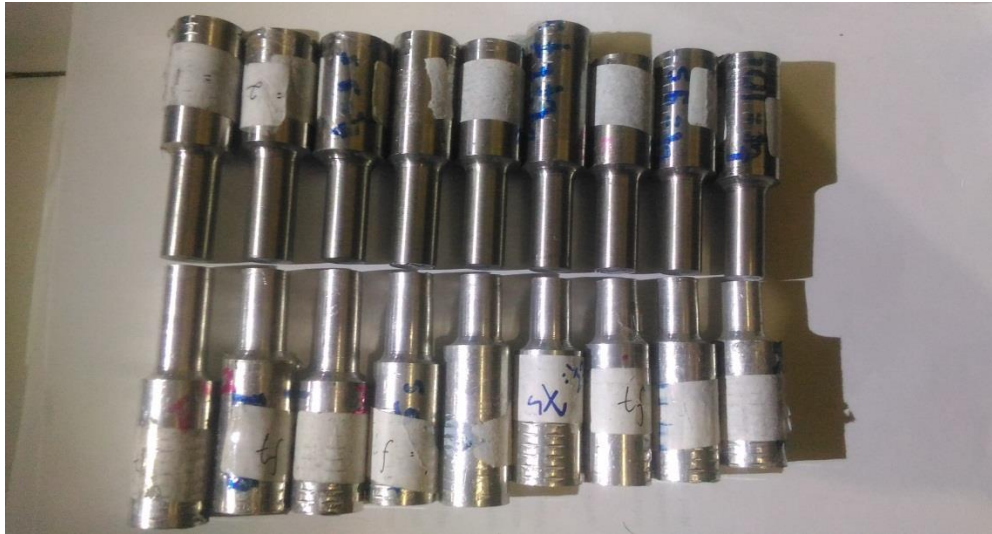
Gambar 4.8 Bentuk spesimen setelah dilakukan pengujian tarik
