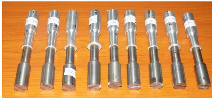
Gambar 4.1 Hasil pengelasan Al 6061 T6 dan SS 304
