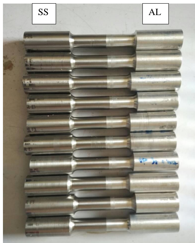
Gambar 4.7 Spesimen uji tarik hasil pengelasan gesek alumunium 6061 T6 dan stainless steel 304 dengan standar JIS Z 2201
