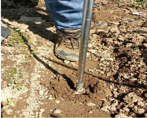
Pengambilan Sampel Tanah Dengan Bor tanah
