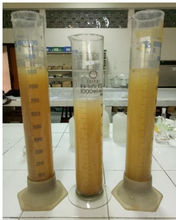
Proses pengendapan dalam Tabung sedimentasi
