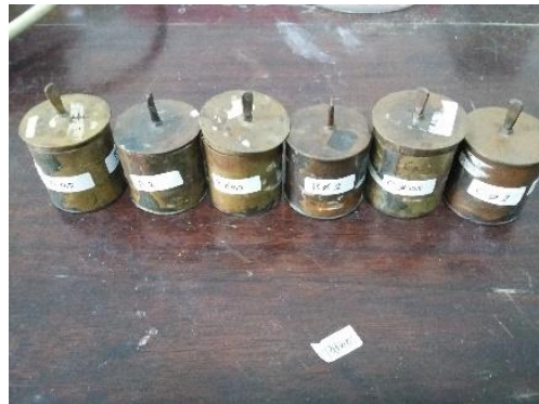
Analisis Kadar Lengas Tanah
