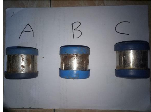
Ring sampel untuk mengukur permeabilitas tanah
