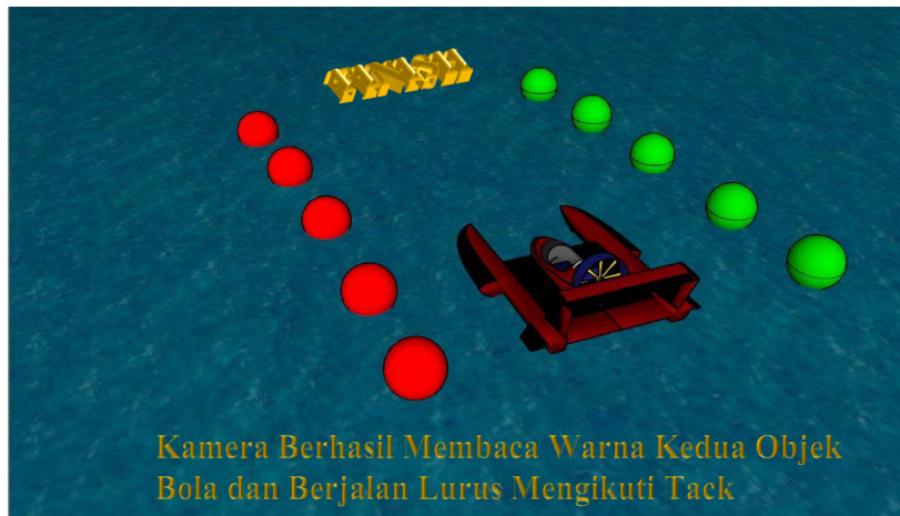
Gambar 3.5 Skenario Ketiga Kamera Berhasil Membaca Warna dan Melaju Lurus Diantara Kedua Bola Tersebut
