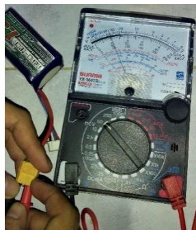
Gambar 4.1 Pengukuran Tegangan Baterai LiPo
