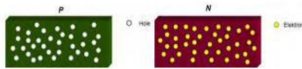
Gambar 2.7 Semikonduktor jenis P dan n sebelum disambung
