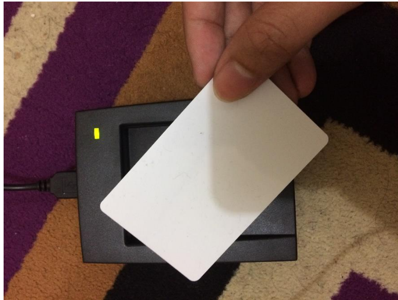
Gambar 4.2 Percobaan Pembacaan RFID Tags
