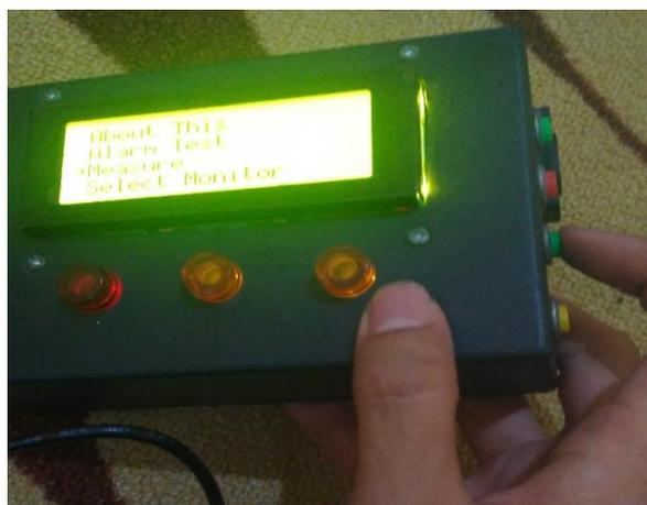
Gambar 4.7 Pengujian *Push Button* Dalam Akses Menu Alat *Monitoring*
