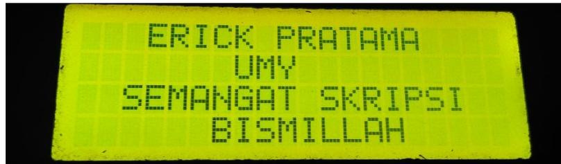
Gambar 4.4 Pengujian *Alphanumeric* LCD Untuk Menampilkan Karakter
