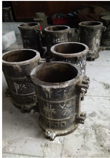
Gambar 23. Persiapan silinder/cetakan beton
