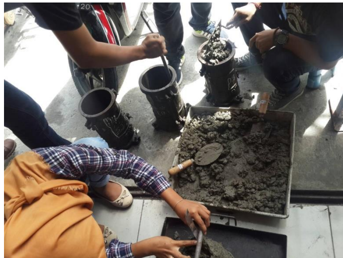
Gambar 27. Proses pencetakan beton segar ke dalam benda uji silinder
