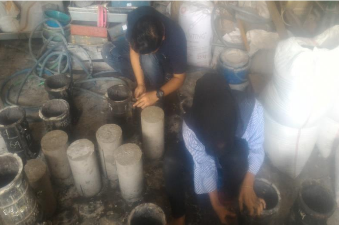
Gambar 29. Proses pelepasan cetakan beton
