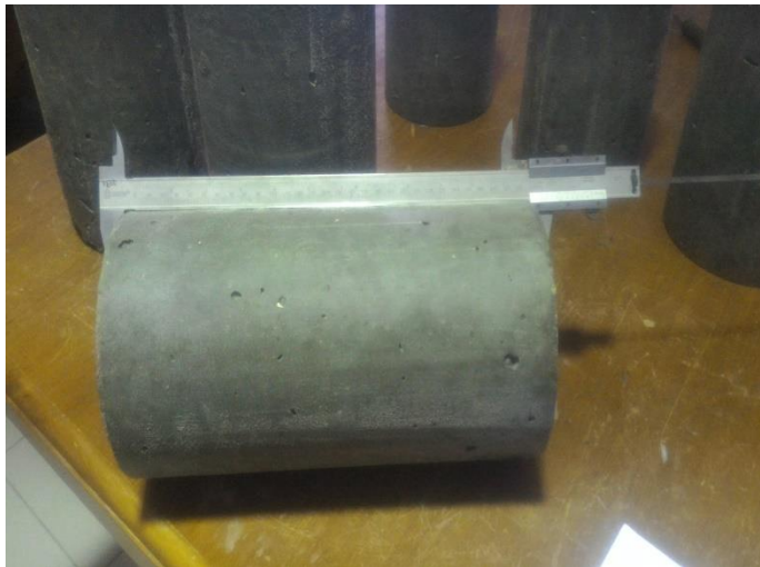
Gambar 32. Pengukuran tinggi beton
