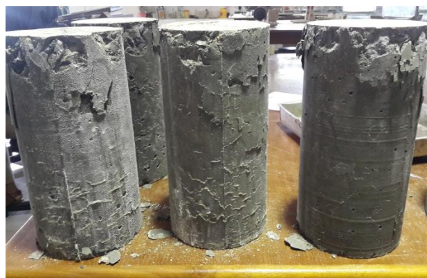
Gambar 34. Beton setelah dilakukan pengujian
