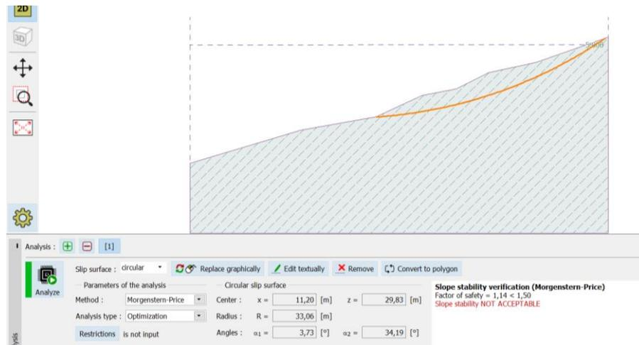
Gambar 6.18 Hasil *analysis* lereng sebelum diberi dinding penahan tanah menggunakan GEO5
