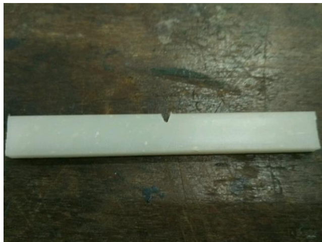
Gambar 2.7 Bentuk spesimen uji impact dengan takikan Sesuai standar ISO 179. (Standar ISO 179, 2000)
