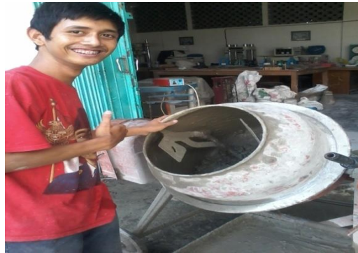
Gambar 4.24 Proses pencampuran beton dalam 1 adukan beton menggunakan concrete mixer
