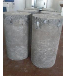
(d) Beton setelah uji tekan
