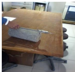
(a) Mengukur dimensi beton
