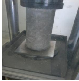
(c) Menguji kuat tekan beton
