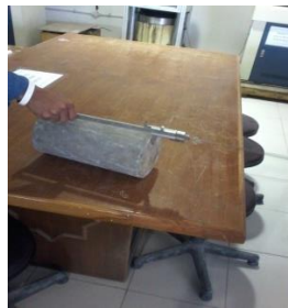
(b) Mengukur dimensi beton
