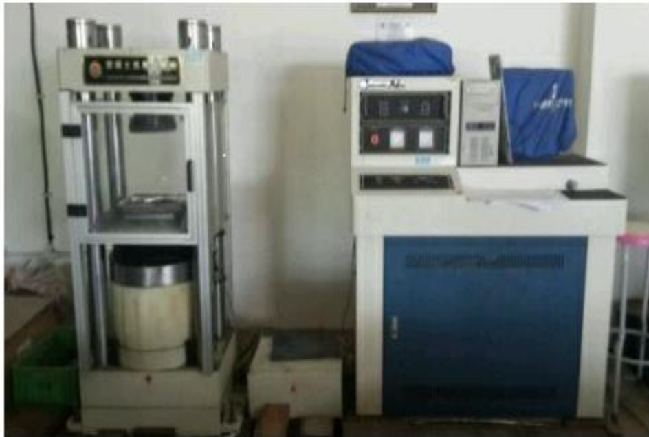
Gambar 4.17 Pengujian kuat tekan silinder beton
