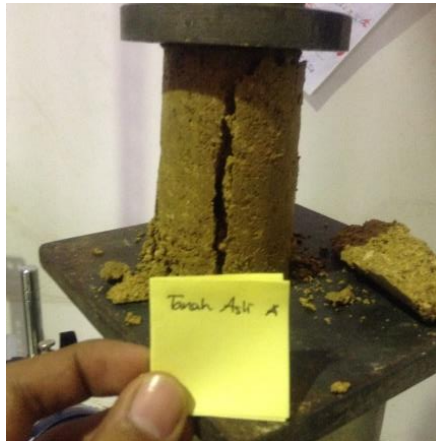
Gambar 3. 12 Benda uji mengalami retakan
